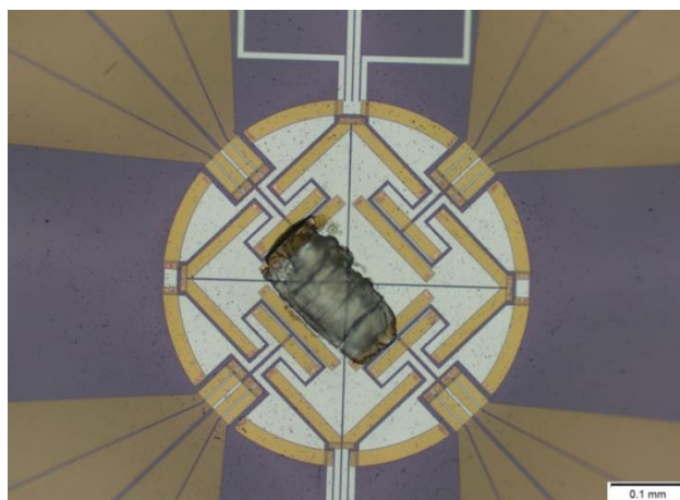
Рис. 2.2. Образец m -терфенила на чип-сенсоре сверхбыстрого калориметра
